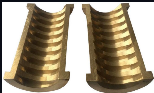
车床开合螺母，毛坯加工到一定程度后再分割
